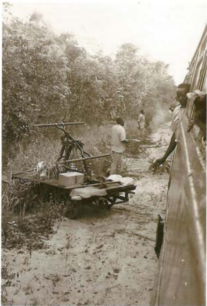
Handlorrie voor het vervoer van personeel voor het verrichten van werkzaamheden op en naast het spoor, omstreeks 1980
